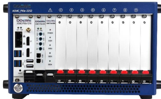
图 1 PXIe 数据采集系统示意图
